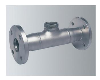
Фитинг изготавливается из нержавеющей стали 1.4571 и предназначен для установки датчика непосредственно в основной технологический трубопровод или байпас диаметром DN50.
